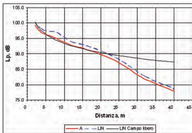
Fig. 3. Livelli di pressione sonora globali in scala lineare ed A misurati in funzione della distanza da una sorgente sonora elettroacustica alimentata con rumore bianco. Per confronto è riportata anche l'ipotetica curva di decadimento in campo libero in scala lineare.
